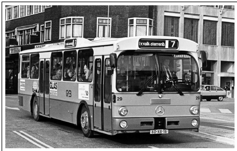
Figură 4-1 Mercedes-Benz OE 305, primul autobuz hibrid Diesel-electric
