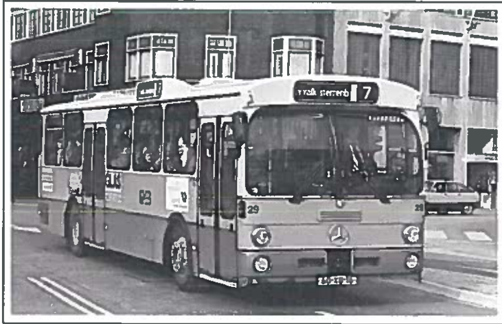
Figură 4-1 Mercedes-Benz OE 305, primul autobuz hibrid Diesel-electric
