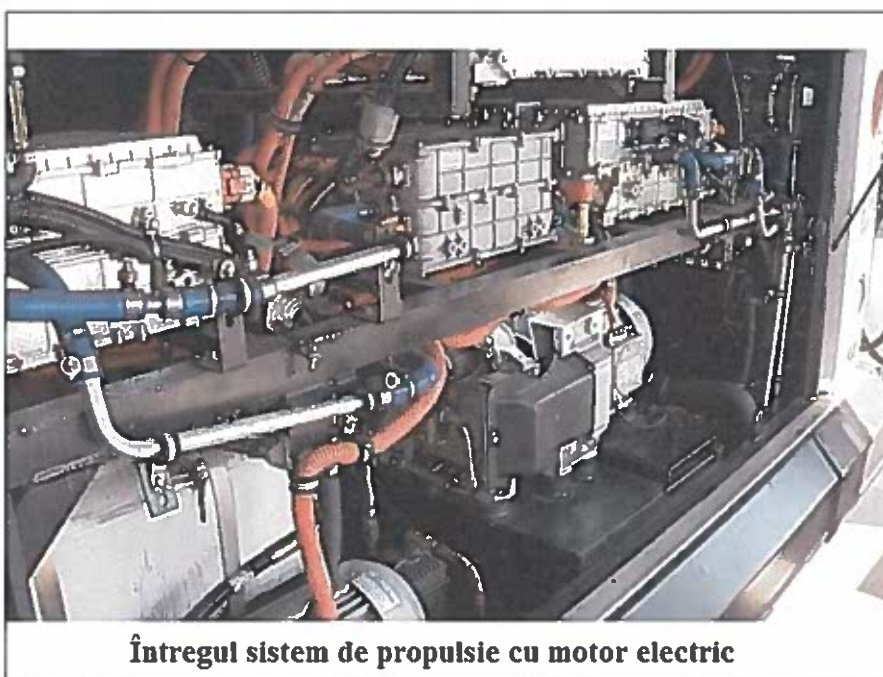
Figură 4-9 Posibilități de montare a motoarelor electrice pentru autobuze
