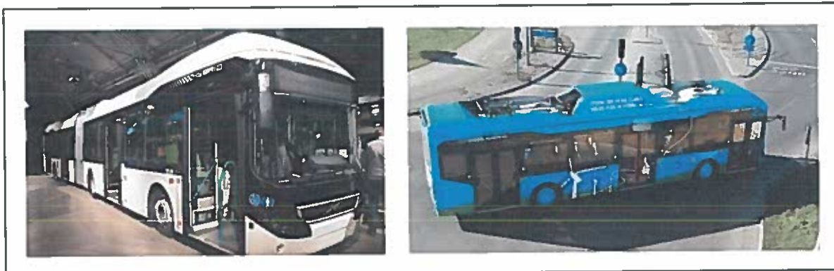
Figură 4-6 Autobuzul Volvo 7900 Hybrid (PHEV) cu posibilitate de încărcare a bateriilor
